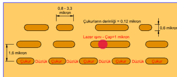
Şekil 2.7: CD iz yapısı
