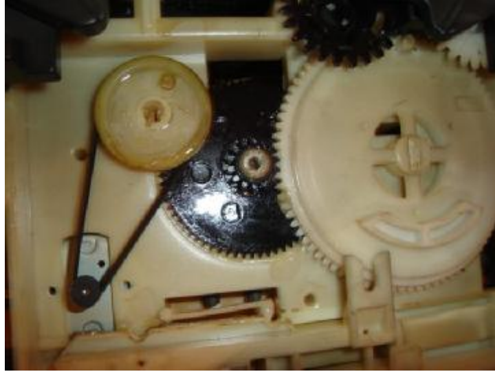
Resim 1.7: CD yükleme mekanığı
