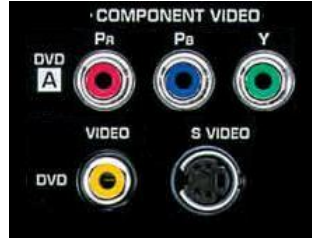
Resim1.1: Amplifikatör/receiver video girişleri
