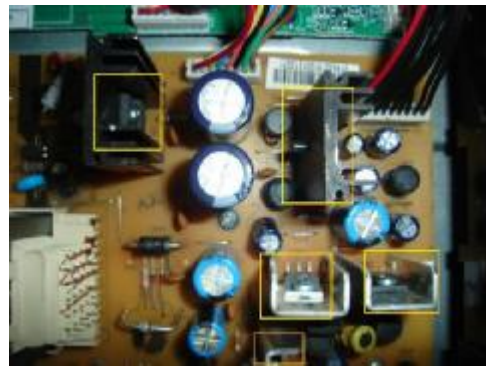
Resim 2.3: Besleme katı transistörleri
