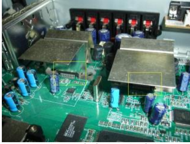
Resim 2.7: Çıkış katı transistörleri
