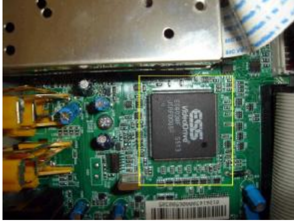
Şekil 2.9: Video sürücü entegresi
