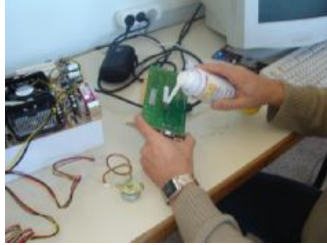
Resim 3.6: Temizleme spreyi ile temizleme
