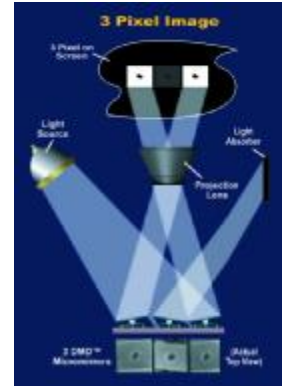
Şekil 1.15: 3 bit DMD ekran görüntüsü
