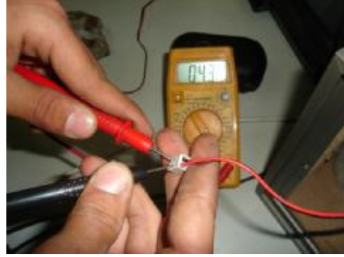
Resim 2.11: Kabin içindeki hoparlörün kontrolü
