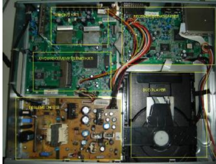
Resim 2.4: Uydu receiver+DVD+amplifikatör/receiver iç görünüşü
