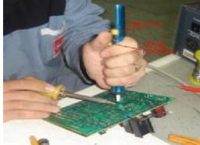
Resim 3.2: Lehim pompası ile lehim sökme
