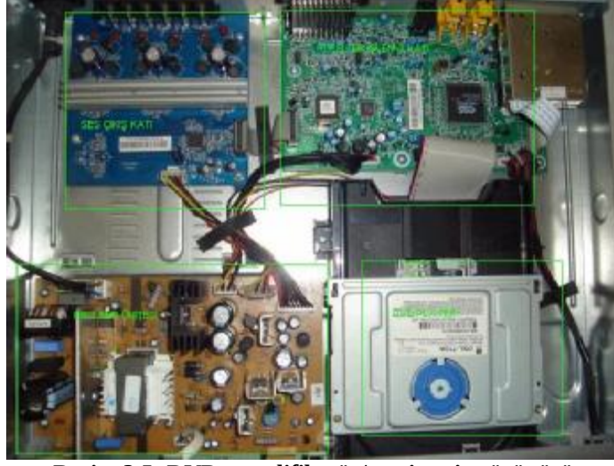
Resim 2.5: DVD+amplifikatör/receiver iç görünüşü
